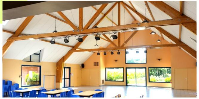
Durant l'été, des travaux ont été réalisés dans la salle La Clairière. Le plafond a été rénové avec le remplacement de l'isolation et des dalles. Un éclairage « Leds » plus économe en consommation a été installé.
