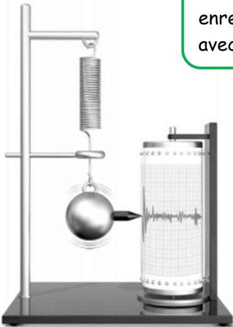
Le sismographe est un appareil utilisé pour enregistrer et mesurer les vibrations du sol qui ont lieu lors des secousses sismiques. Il permet de mesurer leur intensité sur l'échelle de Richter et de prévenir les populations de possibles répliques ou tsunamis à venir. Le sismographe que l'on voit ici possède une aiguille traçante : elle trace sur un rouleau de papier qui tourne lentement les vibrations enregistrées par l'appareil.
