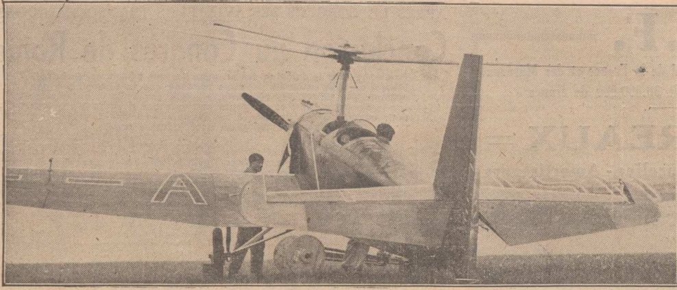
Une vue prise de l'arrière du clinogire Odier-Bessière. Monoplane Caudron 193, moteur Renault 95 CV.
