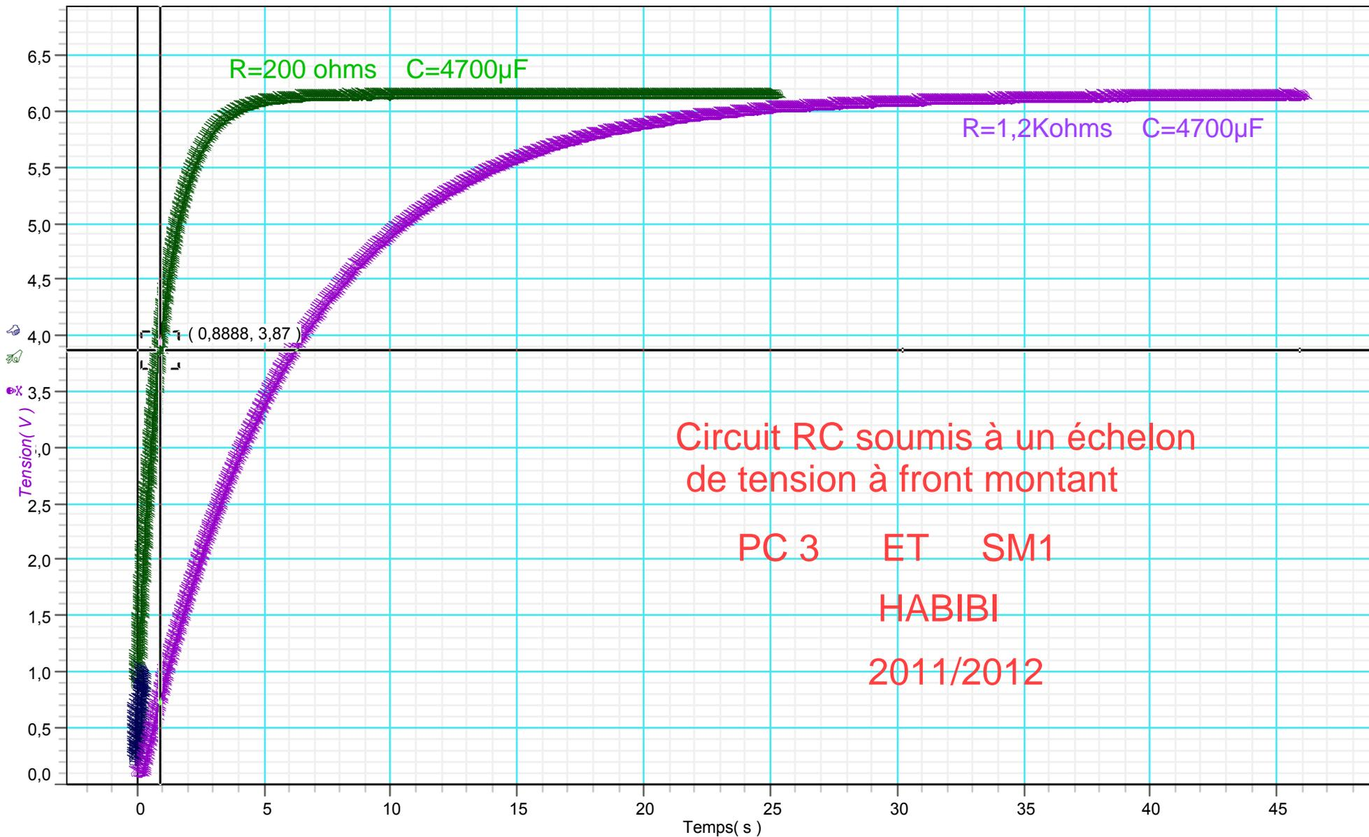
Circuit RC soumis à un échelon de tension à front montant
