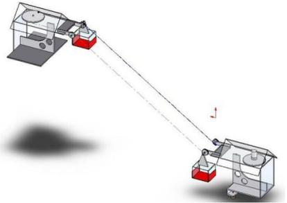
A partir des photos affichées et des observations préalables, ne conserver que les éléments essentiels, à savoir les 2 poulies horizontales et les 4 poulies verticales qui permettent de passer d'un câble «horizontal» à un câble «penché».
