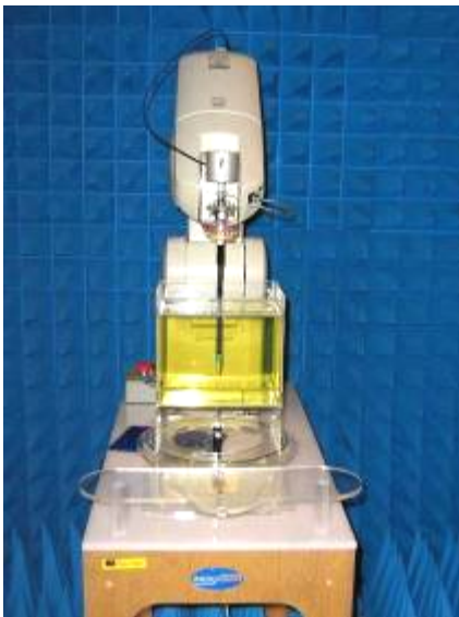
Equipement utilisé pour la mesure de Débit d'absorption spécifique
