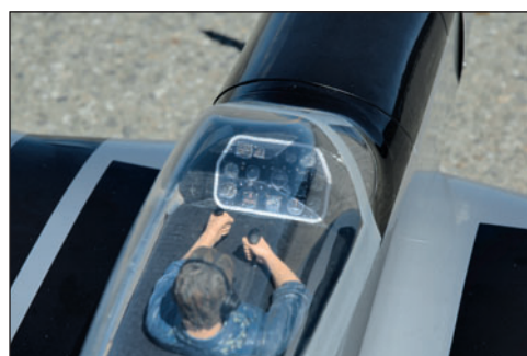
L'auteur a installé un petit buste de pilote ainsi qu'un faux tableau de bord car la grande bulle du P51 aurait paru bien vide.
