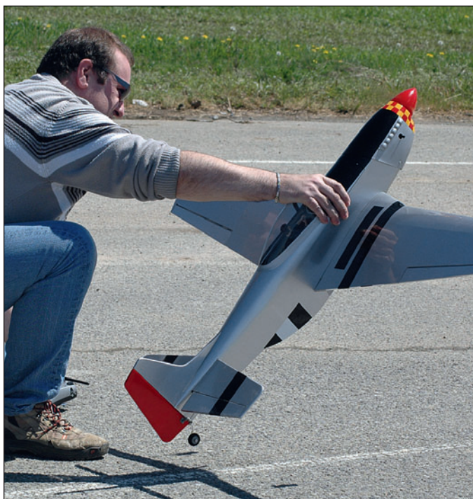
Avec à peine 1,2 m d'envergure, ce petit warbird n'est pas en mousse comme le veut la tendance actuelle mais bel et bien en structure bois classique.
