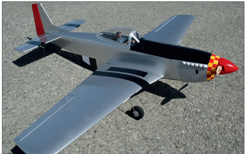
Une fois n'est pas coutume, ce n'est pas un modèle thermique qui a été électrifié, mais bien le contraire ! Le cache culbuteur et l'échappement de l'O.S 26 Surpass sont finalement assez discrets et ne nuisent pas à l'esthétique.
