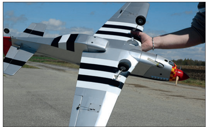
Une fois n'est pas coutume, ce n'est pas un modèle thermique qui a été électrifié, mais bien le contraire ! Le cache culbuteur et l'échappement de l'O.S 26 Surpass sont finalement assez discrets et ne nuisent pas à l'esthétique.
