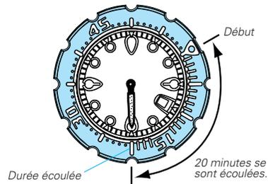
\* Par souci de sécurité, la bague rotative ne peut tourner que dans le sens anti-horaire.
