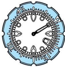
2 Sur la bague rotative, vérifiez le chiffre qu'indique l'aiguille des minutes.
