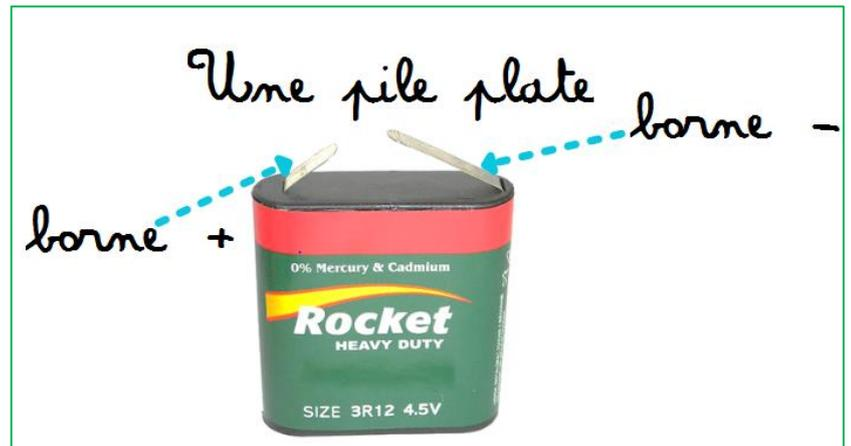
Pour que l'ampoule brille, son culot doit être en contact avec une des bornes de la pile et son plot doit être en contact avec l'autre borne de la pile.
