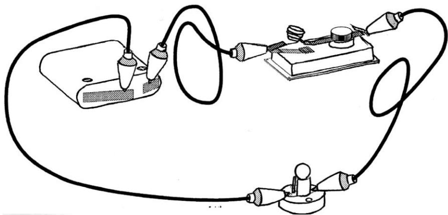
Que dois-tu faire pour que l'ampoule s'allume ? : **fermer le circuit**
