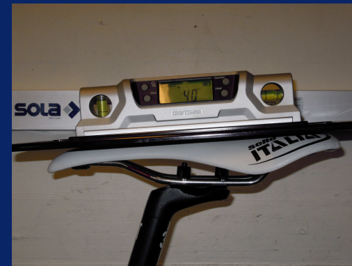
Inclinaison trop importante
