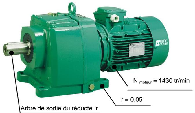
**Q2 : Calculer** la fréquence de sortie ( $N_{\text{réducteur}}$ ) de l'arbre du réducteur.
