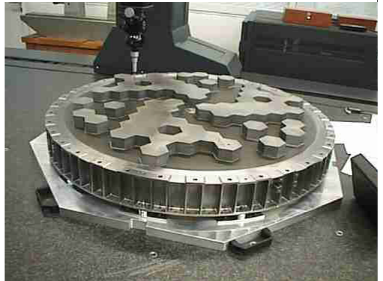
SPI mask : 3 cm thick tungsten
