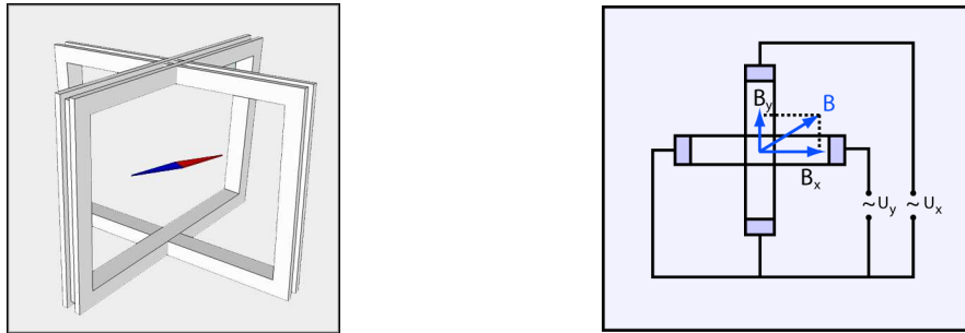
Figure A14 : Champ tournant et courant alternatif. Deux bobines cadres perpendiculaires, parcourues par deux courants alternatifs déphasés de \pi/2 , engendrent un champ magnétique résultant tournant (© Ilarion Pavel).
