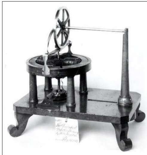
Figure 9 : Moteur de Davenport, formé par deux bobines croisées, qui tournent suivant un axe vertical dans un anneau en bois muni de deux aimants permanents en forme de demi-cercle. Les bobines sont alimentées par un commutateur, visible à l'extrémité inférieure de l'axe (© Smithsonian Museum).
