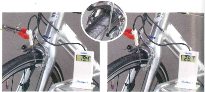
Fig. 1 : Mesure de la température du patin avant freinage.
