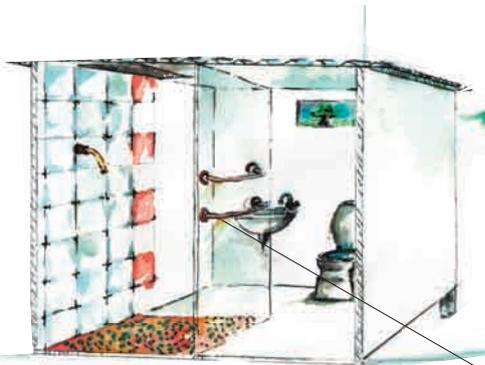
Cette petite pièce comporte un w-c sans eau permettant le compostage des matières fécales grâce à de la sciure de bois, un lavabo et une douche raccordés à un réservoir d'eau de pluie filtrée.
