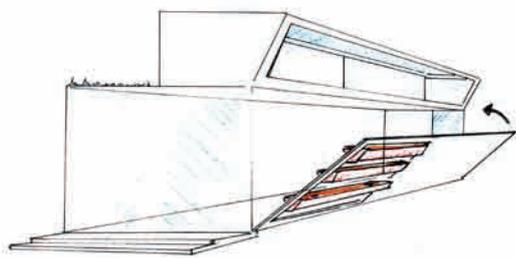
La terrasse est mobile, on peut la relever, ajoutant ainsi un mur de protection pour l'hiver. On y trouve de grands bacs à plantes fixés sur des axes rotatifs, une fois le mur levé les espaces entre ceux-ci sont bouchés à l'aide de plaques coulissantes en verre isolant cachées sous la terrasse.
