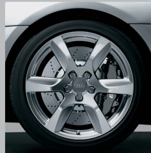
Jantes hiver en aluminium coulé style 6 branches 8,5 J x 18 à l'avant, 10,5 J x 18 à l'arrière, avec pneus 235/40 R 18 à l'avant et 285/35 R 18 à l'arrière, vitesse maximale autorisée 240 km/h, compatibles chaînes-neige
