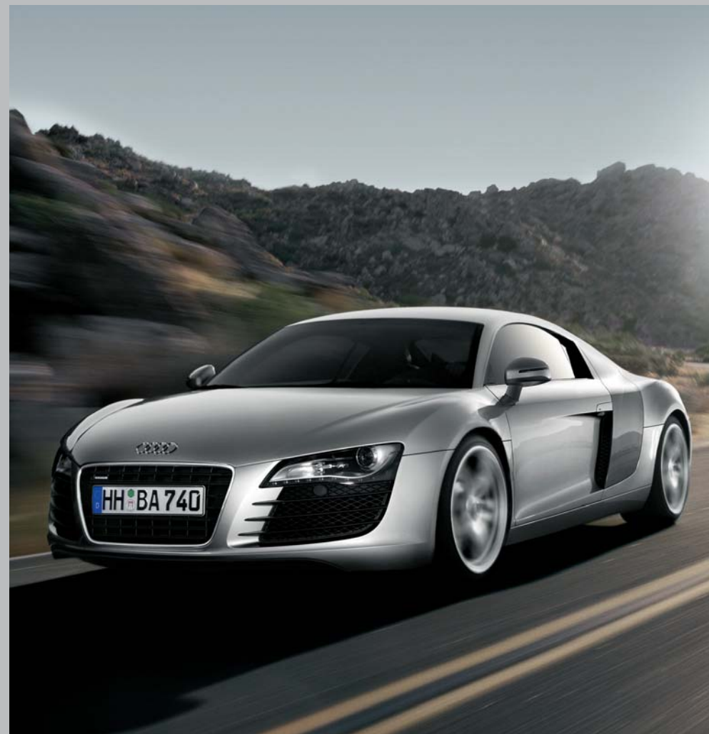
Jantes en aluminium coulé style 6 branches 8,5 J x 18 à l'avant, 10,5 J x 18 à l'arrière, avec pneus 235/40 R 18 à l'avant et 285/35 R 18 à l'arrière. (De série sur R8 4.2 FSI quattro)
