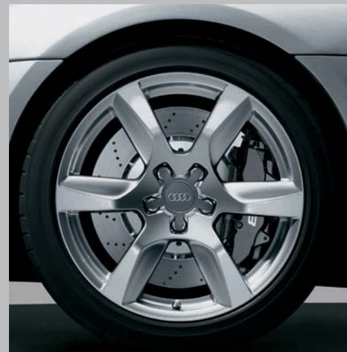
Jantes en aluminium coulé style 6 branches 8,5 J x 18 à l'avant, 10,5 J x 18 à l'arrière, avec pneus 235/40 R 18 à l'avant et 285/35 R 18 à l'arrière. (De série sur R8 4.2 FSI quattro)
