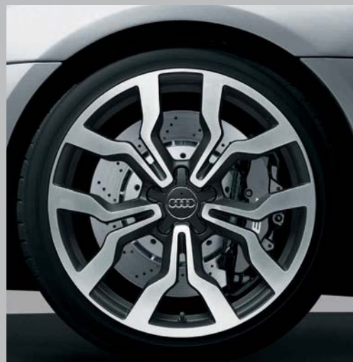
Jantes en aluminium forgé style 10 branches en Y, polies, bicolores, 8,5 J x 19 à l'avant, 11 J x 19 à l'arrière, avec pneus 235/35 R 19 à l'avant et 295/30 R 19 à l'arrière. (De série sur R8 5.2 FSI quattro)
