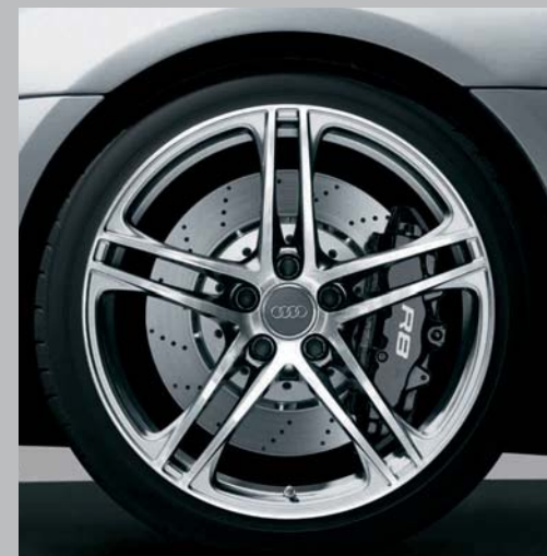
Jantes en aluminium forgé Audi exclusive style 5 branches doubles polies brillant, monochromes, 8,5 J x 19 à l'avant, 11 J x 19 à l'arrière, avec pneus 235/35 R 19 à l'avant et 305/30 R 19 à l'arrière. Une offre de quattro GmbH
