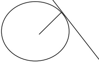
La tangente à un cercle de centre C et un point M est la droite perpendiculaire au rayon [CM] qui passe par M.
