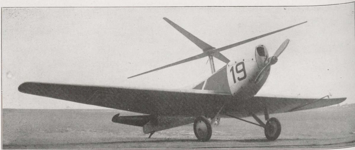
(Photographie de « L'Aéronautique »). Vue trois-quarts avant du clinogyre ODIER-BESSIÈRE; on notera l'effilement des pales de l'hélice sustentatrice.
