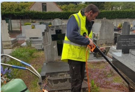
Le désherbeur thermique est utilisé pour les allées, bordures de trottoir et murs de façade, joints de pavés et cimetière.
