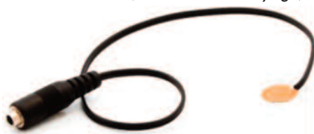
Cordon coupe circuit pour jouets électriques de type marche-arrêt
