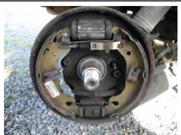
Frein à tambour A l'arrière du véhicule
