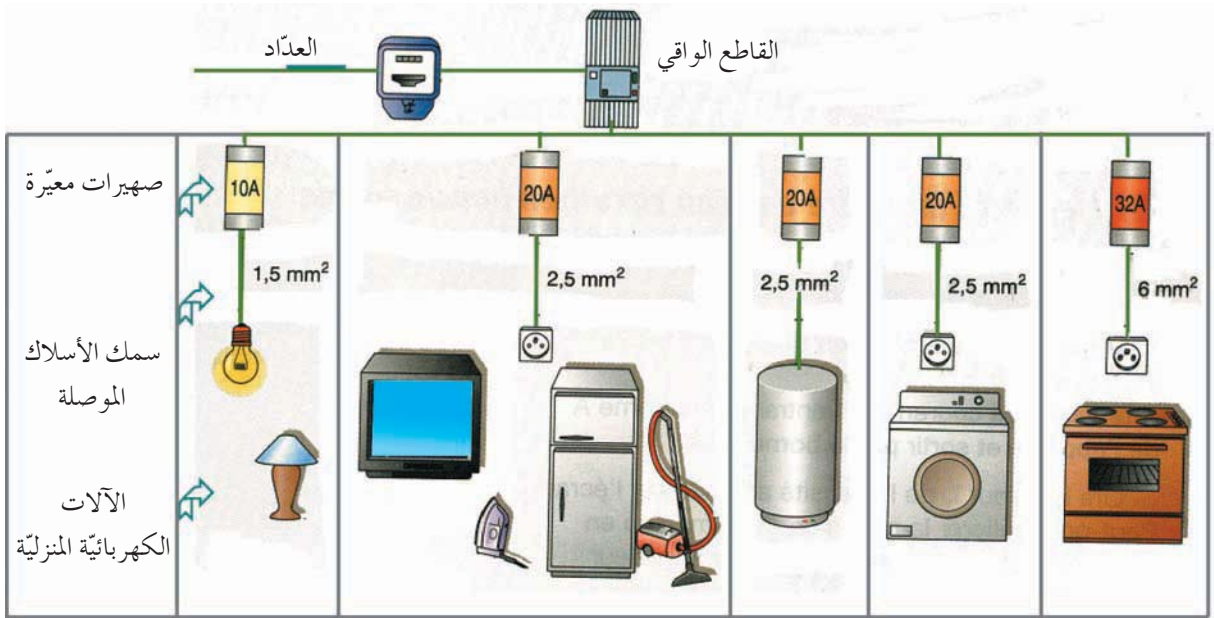
التجهيز الكهربائي المنزلي
