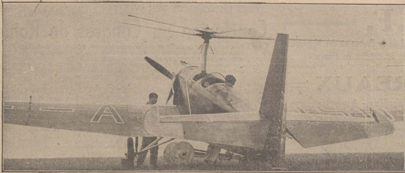
Une vue prise de l'arrière du clinogire Odier-Bessière. Monoplan Caudron 193, moteur Renault 95 CV.
