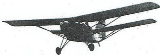
Le SFCA « Taupin » n° 3, équipé d'un moteur bi-cylindre à plat Mengin de 32 ch, avait la configuration type de l'appareil de série (1937).
