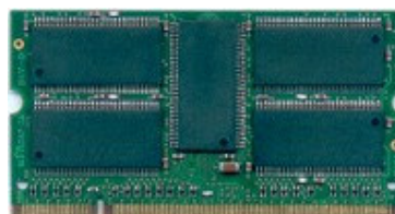
La So-Dimm 200 contacts est équivalent à la DDR.
