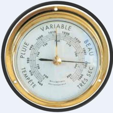
Un baromètre est un instrument qui permet de savoir le temps qu'il va faire le lendemain.
