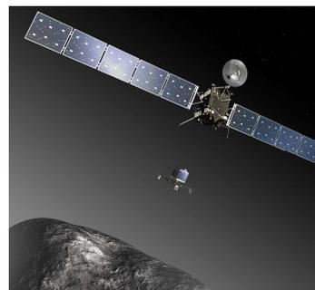
1. La sonde Rosetta est équipée de panneaux photovoltaïques afin de produire l'énergie électrique nécessaire au fonctionnement des différents instruments.
