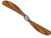
H hélice CHAUVIERE rotation horaire vue place pilote
