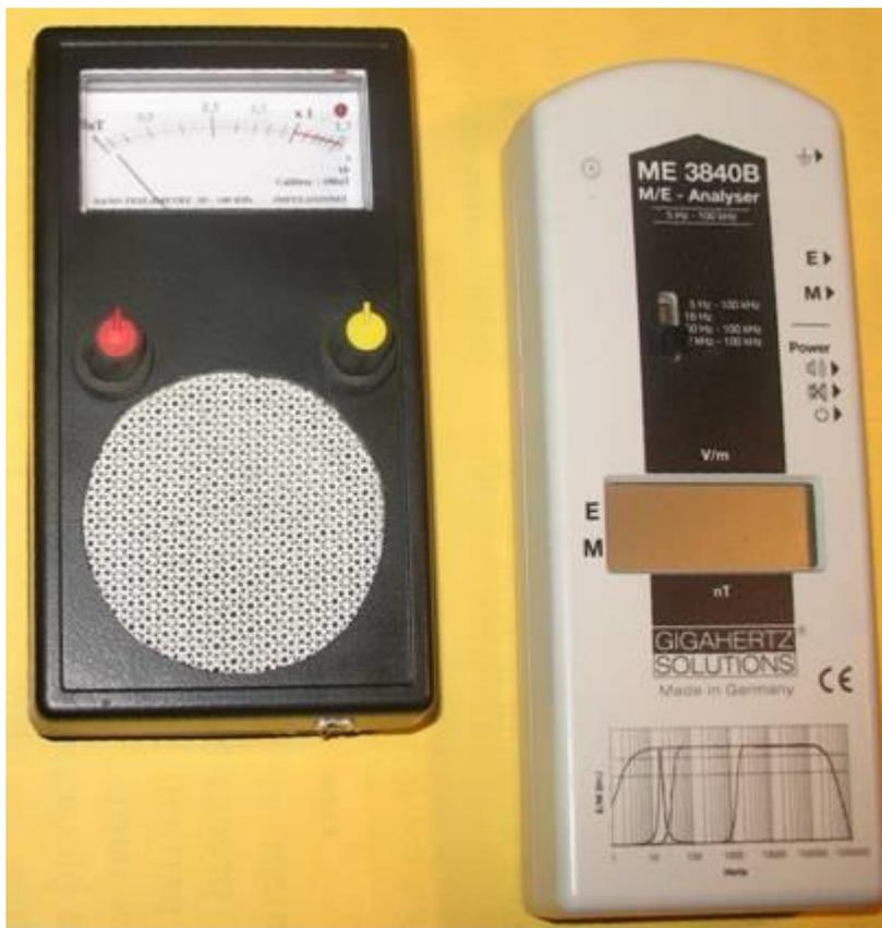
L'appareil de "référence" du commerce utilisé pour l'étalonnage du nanoteslamètre est le **ME 3840B**, de la marque réputée **GIGAHERTZ SOLUTIONS**.
