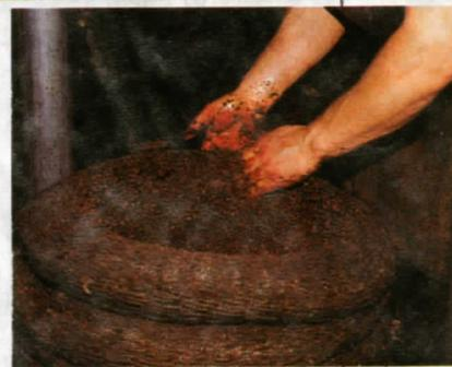
Deux étapes de la fabrication d'huile d'olive : le stockage et le pressurage mécanique dans des plateaux de fibre tressée.
