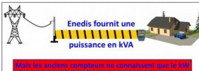
2) La puissance électrique fournie au logement est donc exprimée en kVA, il s'agit d'une puissance nommée Puissance Apparente (en jaune), mais elle se décompose en deux parties :
