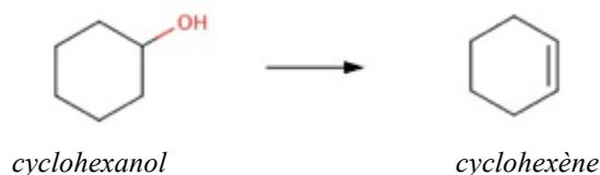
La synthèse est réalisée en présence d'acide phosphorique, qui permet d'apporter le **catalyseur  $H^+$** .
