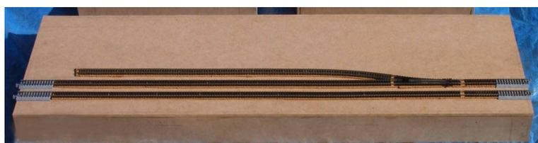
La photo ci-dessus montre un module de triple longueur équipé d'un rail flexible Peco entre les sections de Kato Unitrack® aux extrémités. Une sous-couche en liège de 3 mm est placée sous la voie Peco pour la maintenir à la même hauteur que les rails Kato (le liège est recommandée par rapport à la sous-couche en caoutchouc, surtout pour les nouveaux modélistes, car le caoutchouc donne trop de souplesse).
