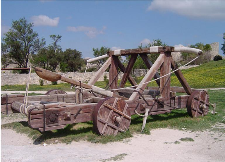
La **catapulte** était une machine qui permettait d'envoyer de grosses pierres. Elle possédait 4 roues, permettant de la déplacer. Une corde tient le bras où sont placées les pierres et c'est en coupant cette corde que les pierres étaient envoyées avec force.
