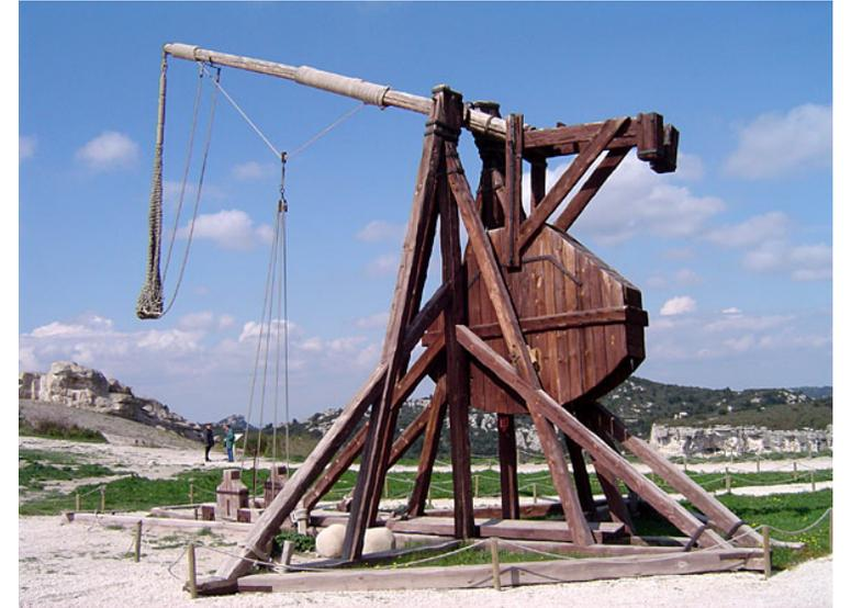
Le **trébuchet** est une énorme balance qui permet d'envoyer des projectiles par dessus les murailles ou de casser les murs. Cette machine pouvait lancer environ 150 kg de pierres à une distance de 300 m.
