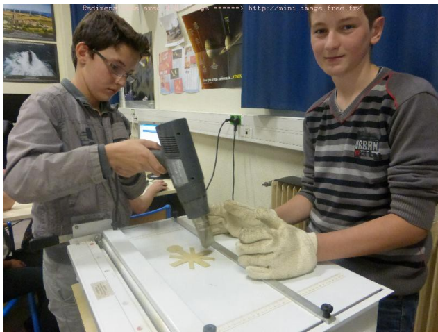
Gillian chauffe la plaque usinée pour pouvoir la plier et finir la nacelle.
