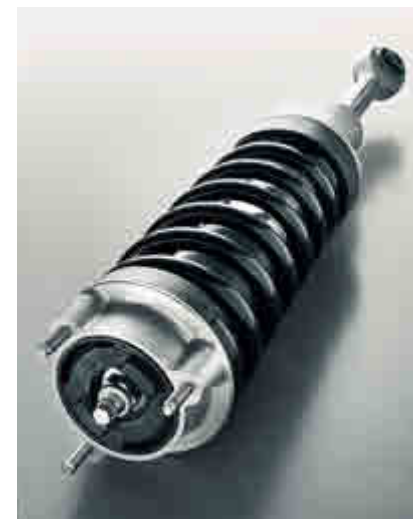
Train de roulement Performance AMG avec réglage encore plus sportif des amortisseurs et des suspensions.
