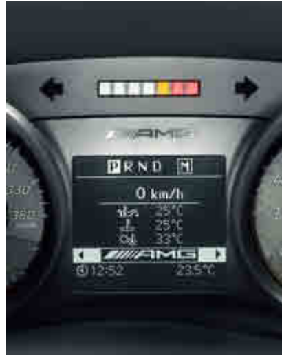
Combiné d'instruments AMG avec indicateur de passage des rapports à 7 LED.
