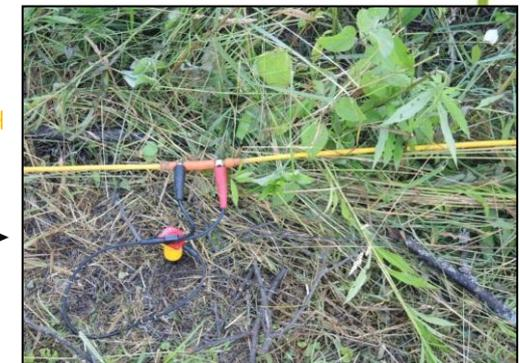
Schéma du dispositif de mesures sismiques aux explosifs
