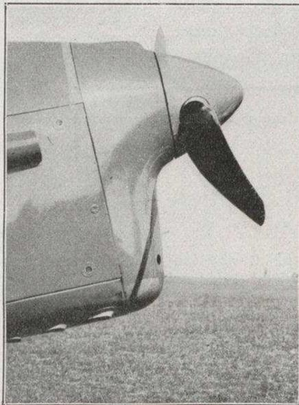
Fig. 1. — L'avant du CAUDRON 366 « ATALANTE »-RÉGNIER 217 HP, équipé de l'hélice à pas variable LEVASSEUR. Noter la flexion des pales vers l'avant.
