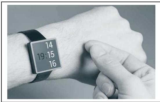
**Pour le projet Soli, les ingénieurs Google exploitent la technologie radar pour détecter des mouvements avec une grande précision. L'idée est de simplifier la manipulation des interfaces des objets connectés tels que les montres. © Google**
