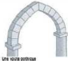
Une voûte ogivale
