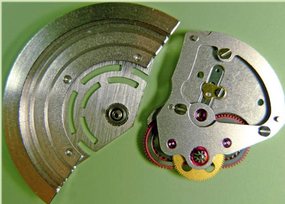
Image 26. L'unité de remontage automatique installée sur le mouvement, sans le rotor. Notez le pont en forme de croissant au-dessus du balancier. En cas de choc frontal de la montre, ce pont empêche que le bord du rotor ne vienne heurter l'extrémité de la serge du balancier.
