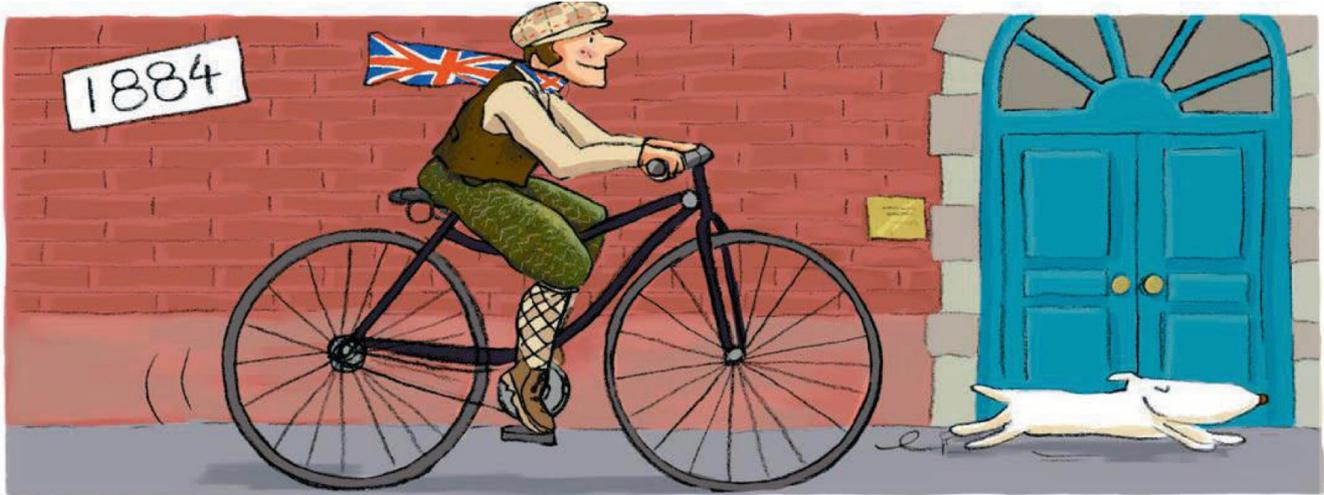
En 1884, un Anglais invente la **bicyclette de sécurité**. Elle a deux roues de la même taille et une chaîne pour entraîner la roue arrière. C'est presque le vélo que tu connais, il manque encore des pneus confortables et un dérailleur pour changer de vitesse.
