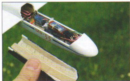
Gros plan sur l'installation radio qui réclame impérativement du matériel au format du planeur, c'est-à-dire micro.
