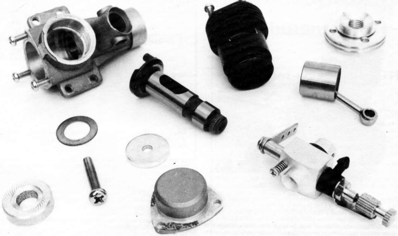
Le G. Mark en pièces détachées. Notez le diamètre imposant du vilebrequin et la généreuse section pour le passage des gaz frais. Remarquez aussi la forme triangulaire du bouchon de carter et du carter proprement dit.
