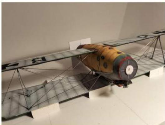
Il est réalisé en tiges de corde à piano de 0.3mm. Le diamètre est un peu fort pour l'échelle mais c'est le plus petit diamètre disponible sous forme de tige. Les diamètres inférieures sont disponibles uniquement en rouleaux et, de ce fait, particulièrement difficiles à redresser.
