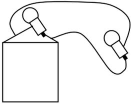
Les deux ampoules sont sur des chemins différents (montage en parallèle). Elles brillent comme une seule ampoule. Si on dévisse une ampoule, l'autre reste allumée.
