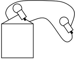
Les deux ampoules sont sur des chemins différents (montage en parallèle). Elles brillent comme une seule ampoule. Si on dévisse une ampoule, l'autre reste allumée.
