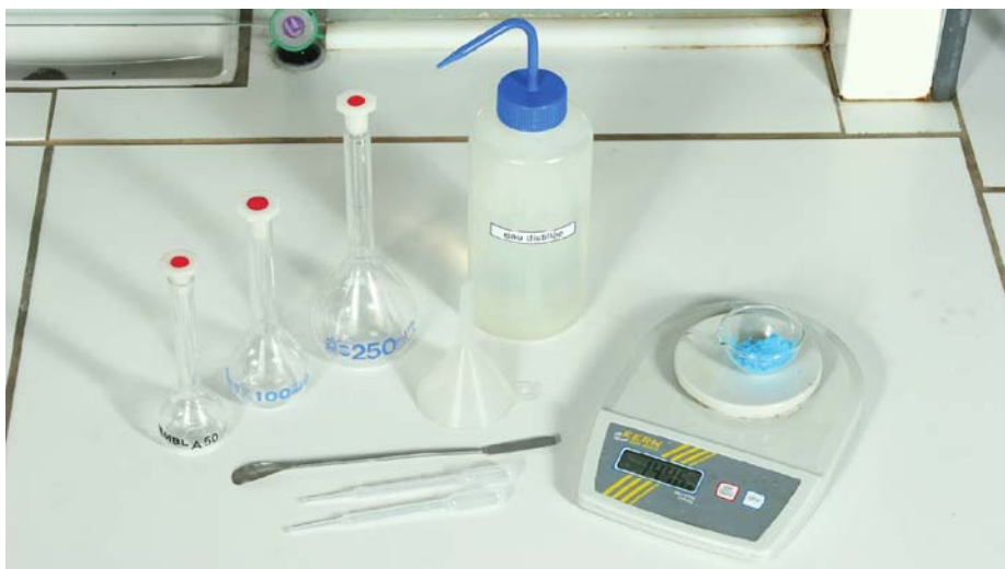
doc. 1 Le matériel à utiliser pour la préparation d'une solution par dissolution.
