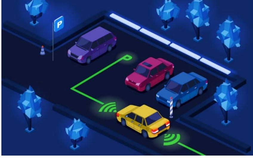
**Les détecteurs** intégrés dans le **sol** peuvent être utilisés pour **identifier** les places de **stationnement** disponibles ou occupées.
