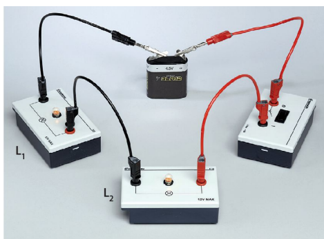
Fig. 2 : Les lampes L_1 et L_2 sont branchées en série.
