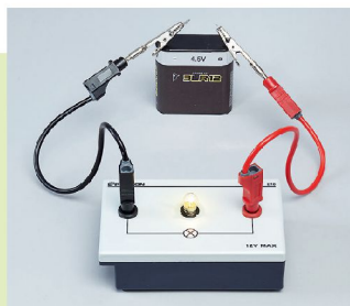
Fig. 1 : Circuit comportant une pile et une lampe.
